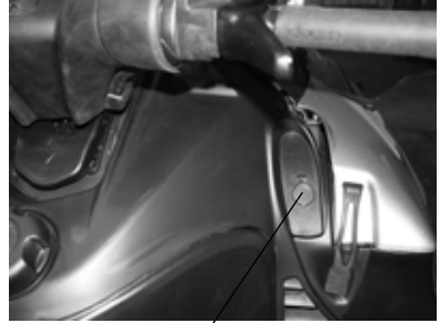
12-Volt DC Outlet
